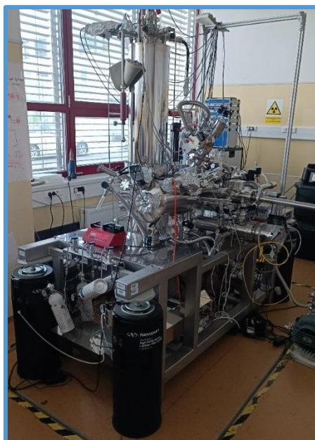
Obrázek 6: Nízkoteplotní mikroskop s atomárním rozlišením (foto: Auditní orgán)
