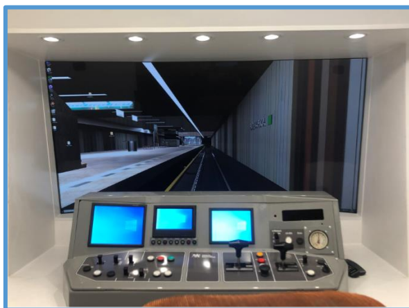
Obrázek 9: Univerzální výcvikový simulátor vozidla MHD (foto: auditní orgán)
